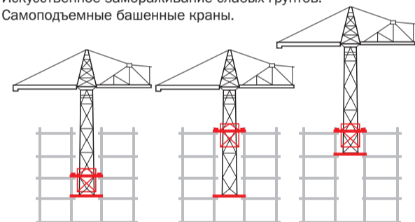
Как «ползет» по этажам самоподъемный кран (тип УБК, сконструированный специально для первых высоток). Кран имеет передвижную обойму (выделена красным), которая после монтажа очередного яруса стального каркаса поднимается на два этажа вверх. Затем при помощи электрической лебедки поднимается сам кран и закрепляется. Современные аналоги используются при строительстве большинства небоскребов.
